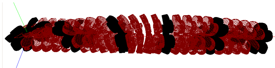
Figur 2: Eksempel på imellem-bevægelse. Røde (hullede) firkløvere er interpolerede positioner, sorte (udfyldte) er kendte positioner.
